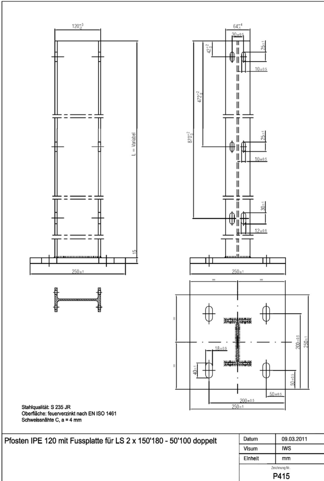
Abb. 2.7 Pfosten IPE 120 mit Fussplatte.
