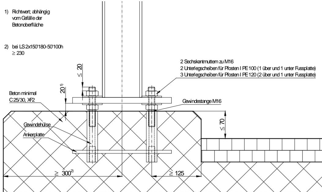
Abb. 4.10 Pfosten mit Fussplatte und Ankerplatte mit Gewindehülsen.
