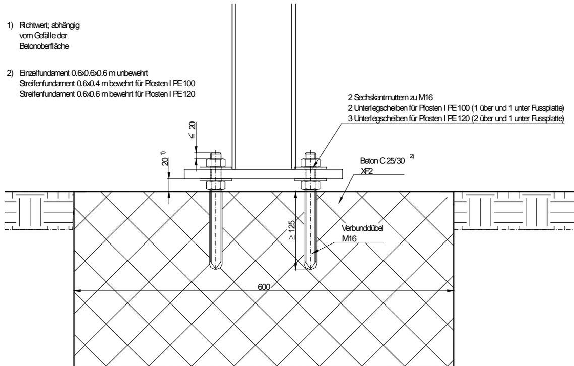
Abb. 6.6 Pfosten mit Fussplatte und Verbunddübel in Einzel- oder Streifenfundament.
