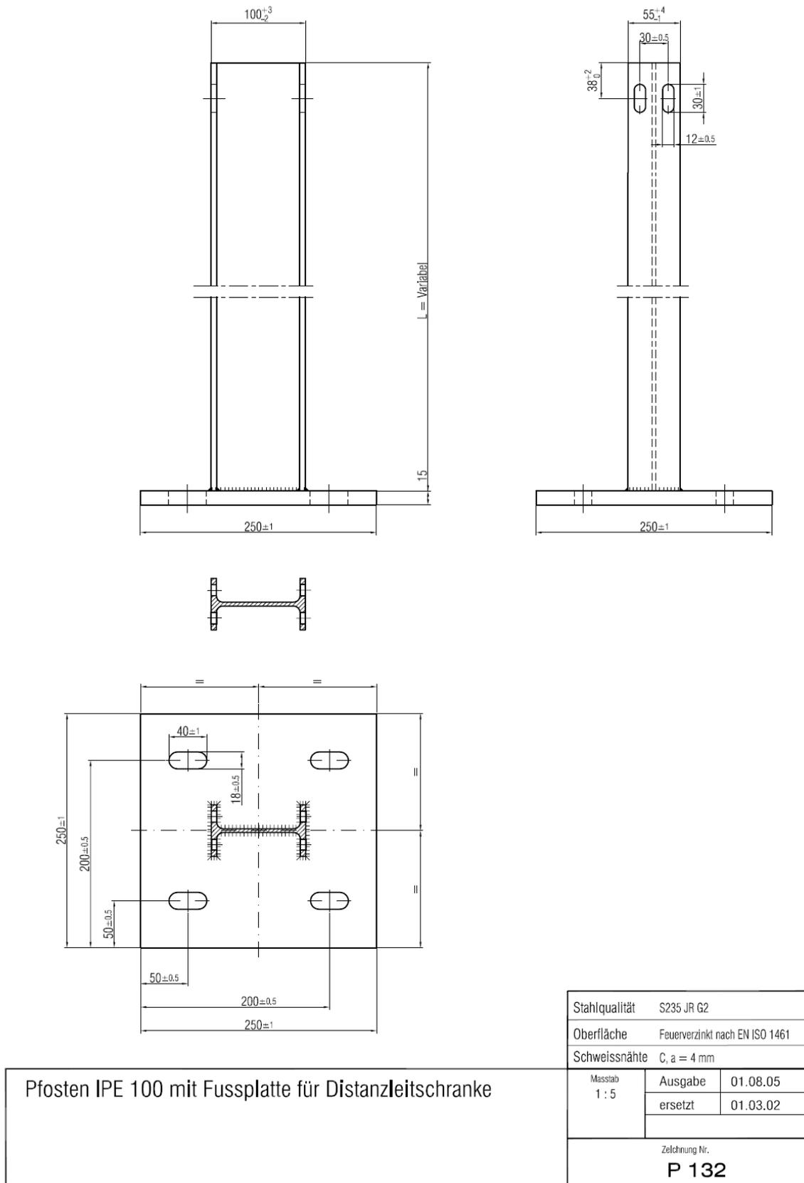
Abb. 2.7 Pfosten IPE 100 mit Fussplatte.
