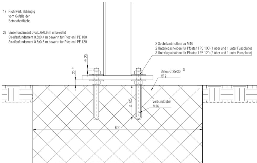
Abb. 4.7 Pfosten mit Fussplatte und Verbunddübel in Einzel- oder Streifenfundament.
