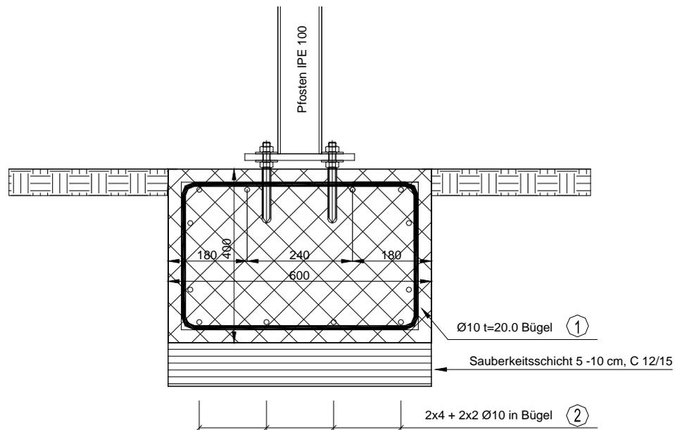
Abb. 6.5 Streifenfundament bei Pfosten IPE 100.
