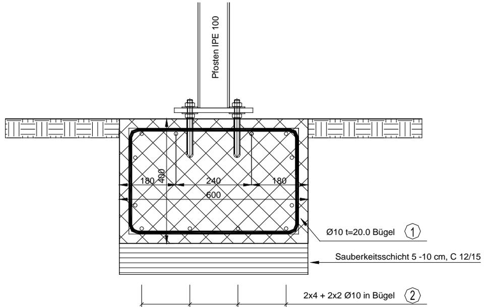
Abb. 4.6 Streifenfundament bei Pfosten IPE 100.
